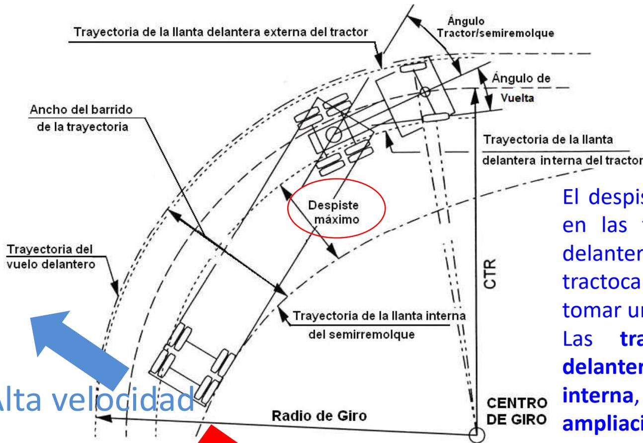
El despiste máximo es la diferencia en las trayectorias de las ruedas delanteras y traseras de un tractocamión/semirre-molque al tomar una curva.
